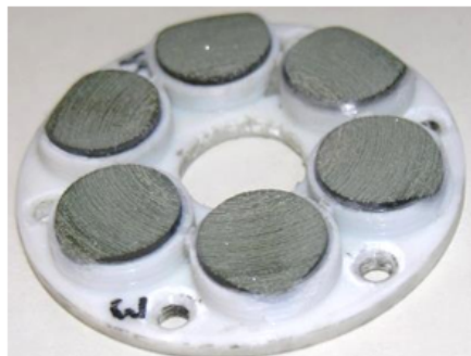
Rys. 2. Narzędzia diamentowe po badaniach eksploatacyjnych (a) wraz z betonową płytą ścierną (b)
