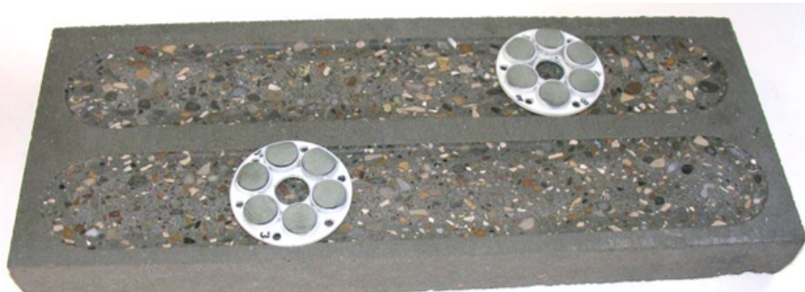
Rys. 2. Narzędzia diamentowe po badaniach eksploatacyjnych (a) wraz z betonową płytą ścierną (b)
